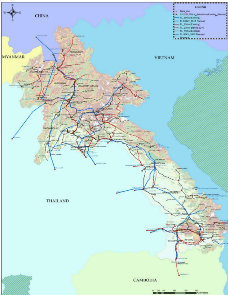
图 5.2-3 老挝电网地理接线图
