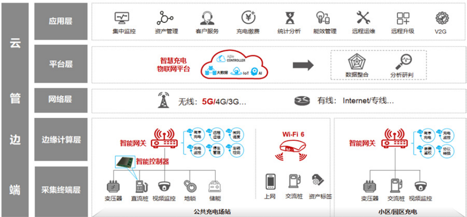
图 15 聚合软件平台的系统架构
