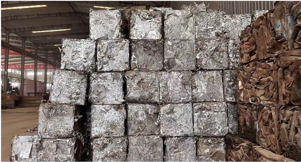
图2-8 废钢铁打包块
